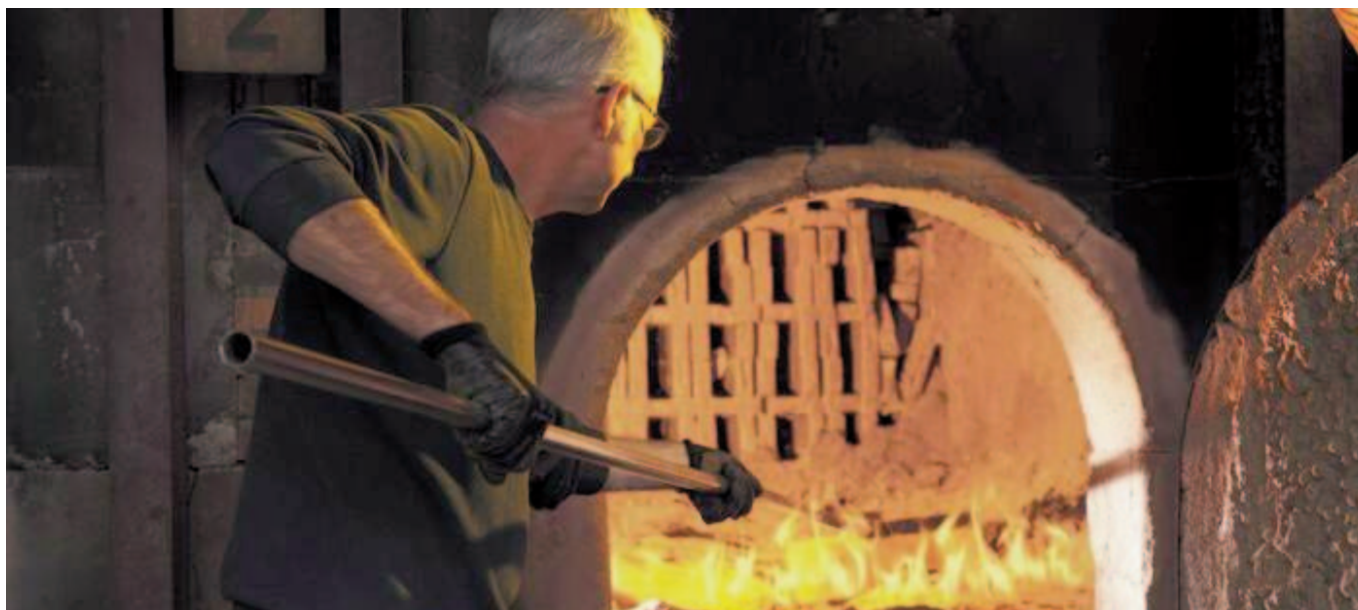
Four à bois pour la fabrication de produits en terre cuite, société Rairies Montrieux.
