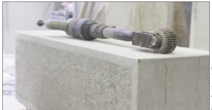
Travail de bouchardage sur une pierre de taille à l'usine des Carrières du Bugey.
