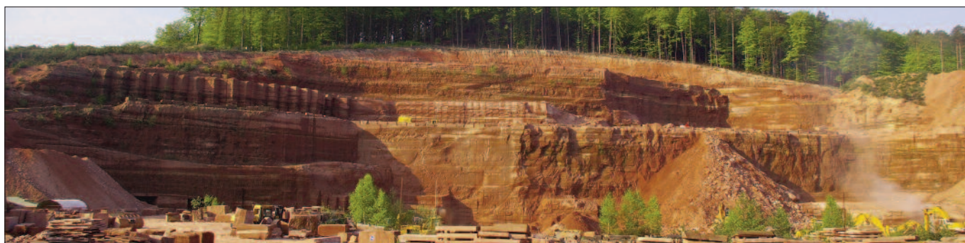
Vue panoramique de la carrière aérienne. Le découpage des blocs s'effectue au jet d'eau.
