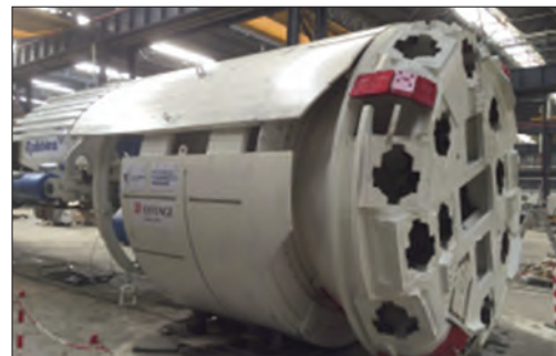
Le tunnelier Augustine dans l'atelier de son fabricant Robbins.
