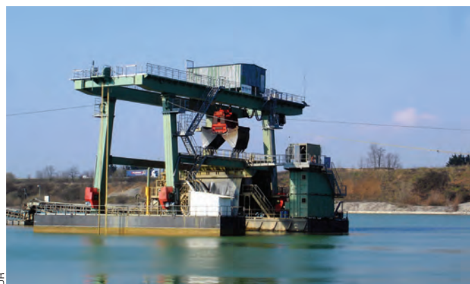
À Baldersheim, l'extraction dans le lit majeur du Rhin est réalisée à la drague flottante, d'une capacité de 15 m 3 , jusqu'à une profondeur de 45 m.
