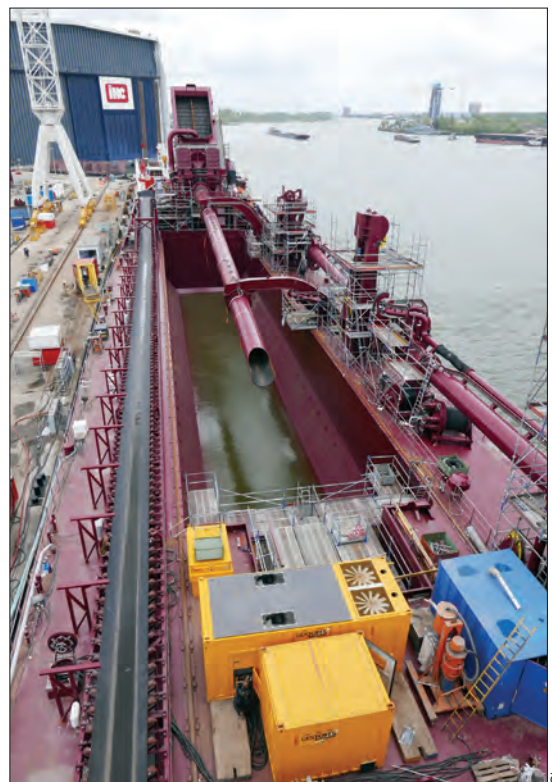
Vue depuis le château arrière : la trémie de chargement des granulats offre une capacité de 5 450 m 3 , son tube de remplissage et le crible relevé. À gauche, le deuxième convoyeur. À droite, le tube de l'hélice.
