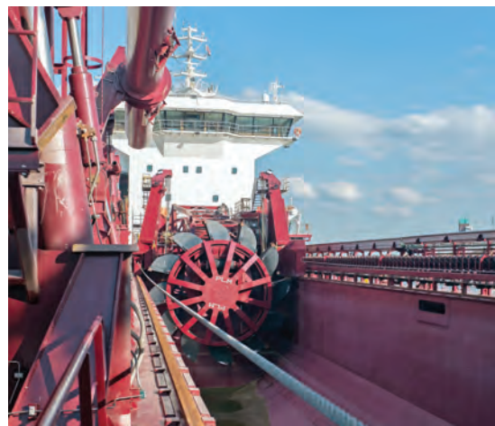
La roue à godets, qui puise les granulats dans la trémie, se déplace sur des rails grâce à un câble.
