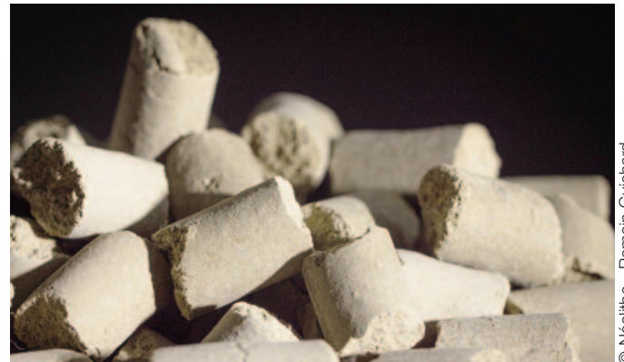
Anthropocite, granulats de substitution pour béton non structurel issus de la fossilisation accélérée des déchets.
