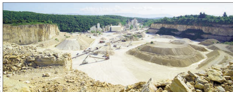
La carrière de La Gagne exploite un calcaire oolithique mésoporeux.
