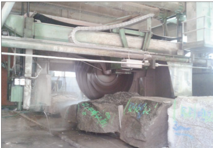
Sciage des blocs bruts
